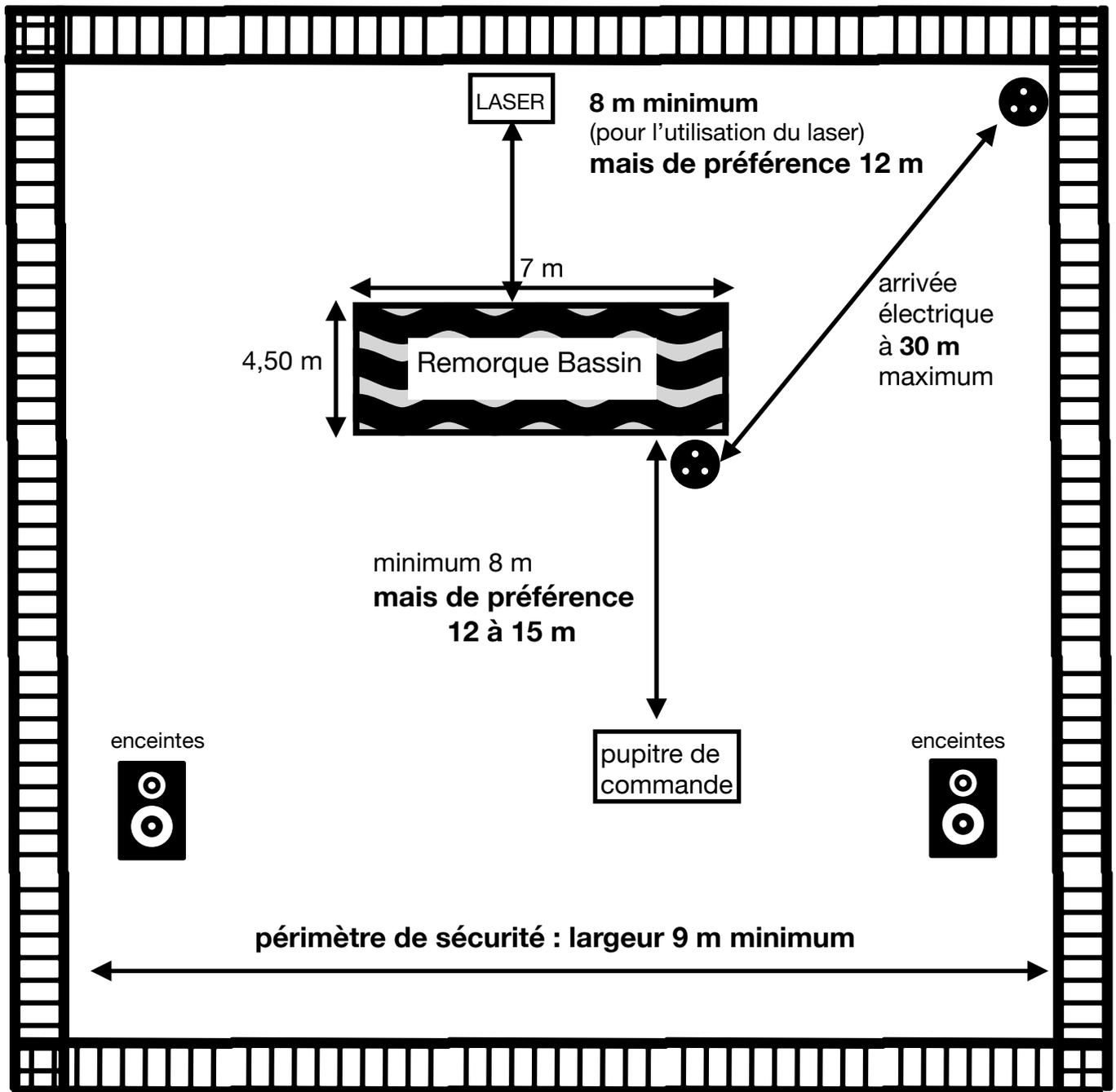
Largeur 18 m minimum pour manoeuvrer avec l'ensemble roulant de 13 m.
